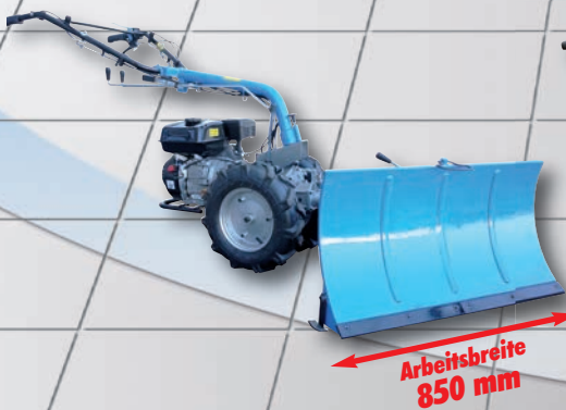
Abb. Schneeschild montiert an Motoreinachsler
